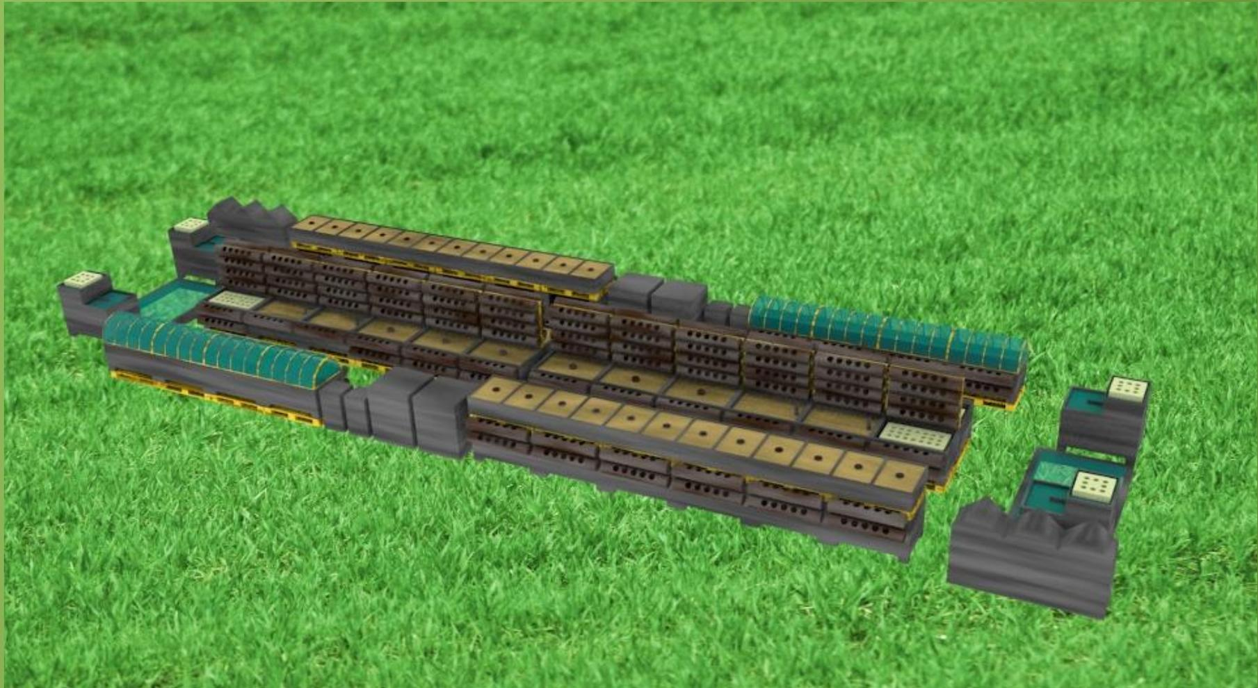
Realizzare presso un orto urbano un impianto di 120mq come in figura, telecontrollato con Arduino e rete IoT che funge da dimostrativo per i potenziali clienti e da test per nuovi prodotti
